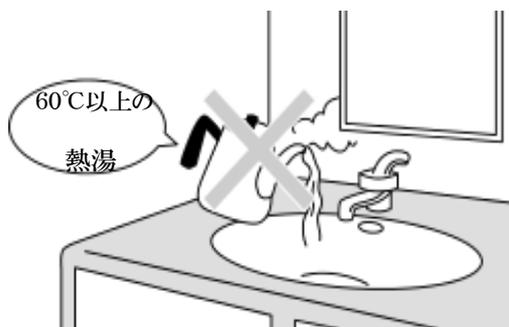
排水時に配水管が熱で膨張して排水管から音がする場合があります。
